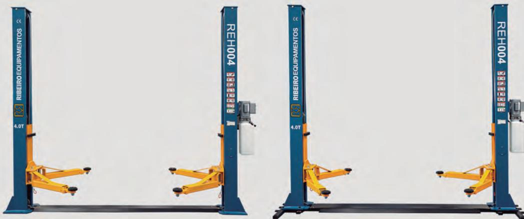
Elevador Automotivo Hidráulico Monofásico com capacidade para 4 Toneladas. Destrava bilateral manual, braços simétricos com sistema de trava dentada do ângulo de abertura e na cor amarela para melhor visualização, afim de evitar acidentes. Conta também com trava mecânica nas colunas como mais um dispositivo de segurança.
